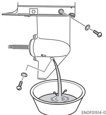
3. Introduisez l'injecteur du tube d'huile dans l'orifice du bouchon d'huile inférieur et remplissez le réservoir avec de l'huile pour embase en appuyant sur le tube jusqu'à ce que l'huile atteigne l'orifice du bouchon d'huile supérieur.
