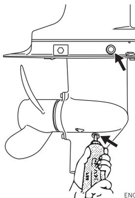
4. Placez le bouchon d'huile supérieur, puis retirez l'injecteur du tube d'huile avant de replacer le bouchon d'huile inférieur.
