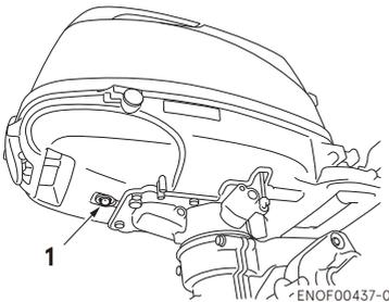
1. Orifice de contrôle de l'eau de refroidissement
